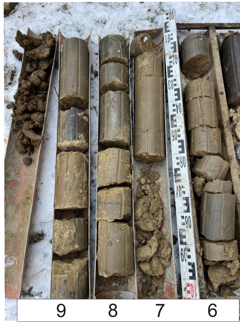
Fotodokumentace vývrtu ze sondy V-2
