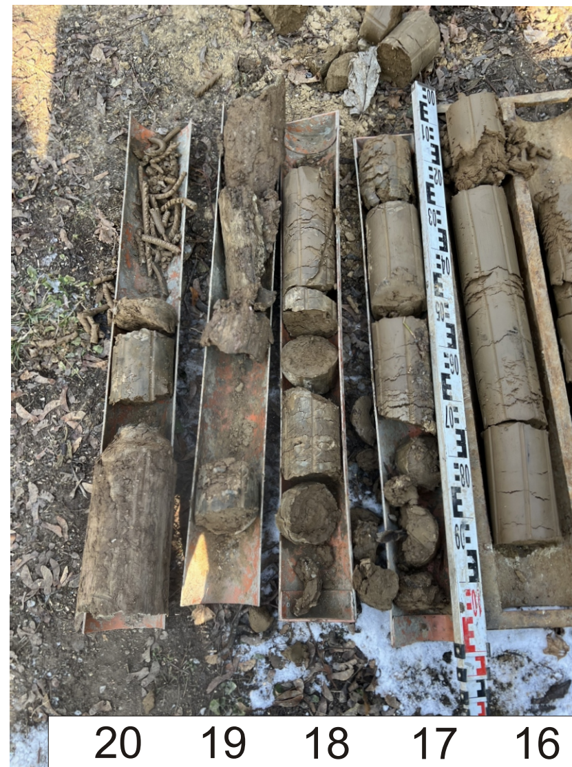
Fotodokumentace vývrtnu ze sondy V-1
