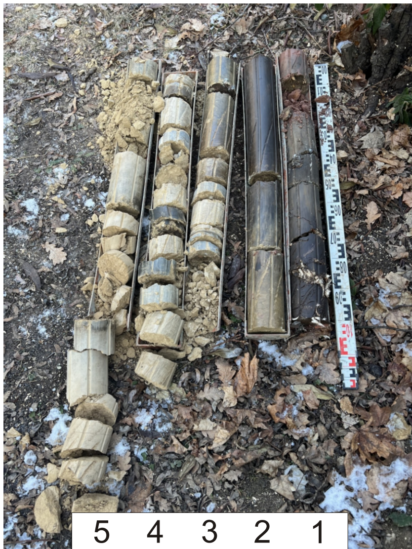
Fotodokumentace vývrtu ze sondy V-1
